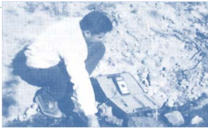
Figura 12. Medidor de la conductividad con sensores
