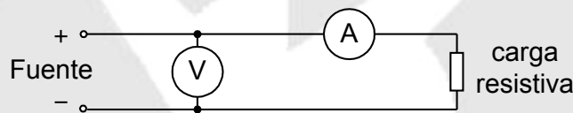
Fig. 3.18 Medición indirecta (con voltímetro y amperímetro).
