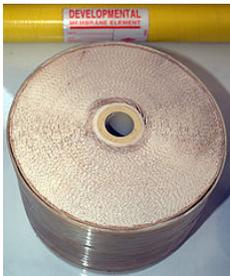
[Bobina](#) de membrana semipermeable empleada en la [desalinización](#) del [agua salobre](#).
