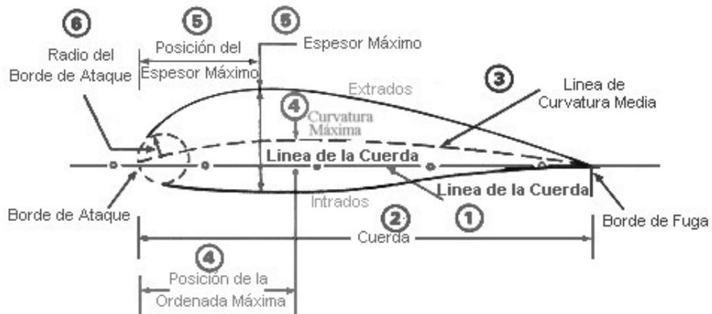
Fig. II.7 perfil aerodinámico
